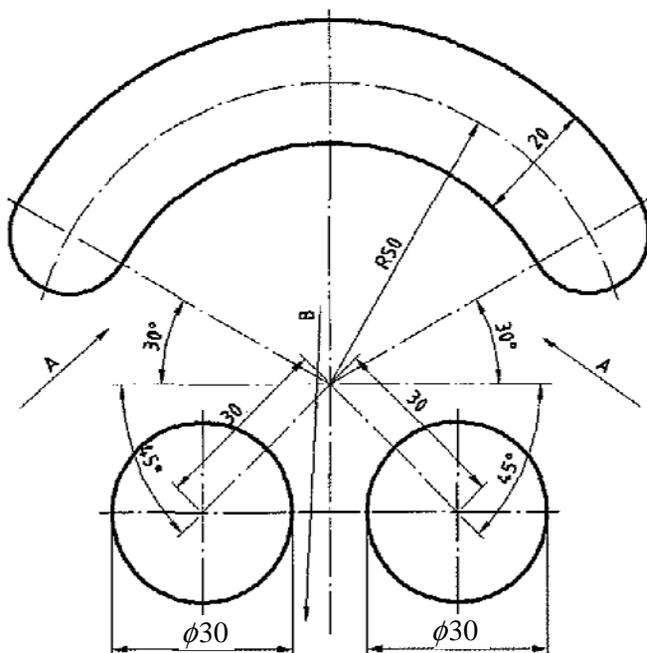
四、請依下列正投影視圖所示之尺度，以比例 1：1 繪製等角圖（非等角圖不予計分），不必標註尺度，等角圖尺度誤差值超過正負 2 mm 處不計分，等角圖之視角必須能顯示前視圖與右側視圖。（25 分）
