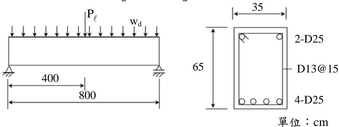
二、(一)試檢核圖示鋼筋混凝土梁柱構架中 A-A 斷面之撓曲強度是否足夠？(18分)
