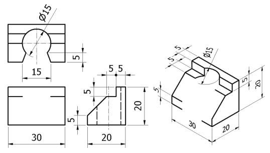
二、請依立體圖所示之尺度以比例 1:1 繪製其俯視圖、前視圖及左側視圖(不用標註尺度)。(30分)
