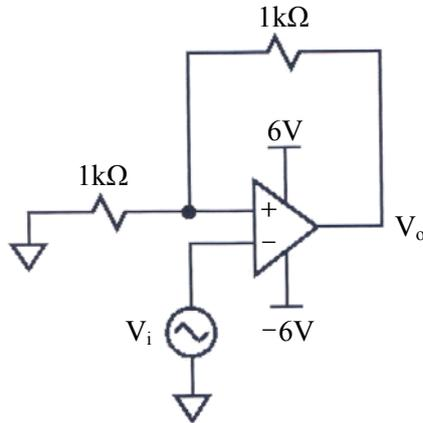
3 圖中理想運算放大器電路的輸出電壓  $V_o$  為何？
