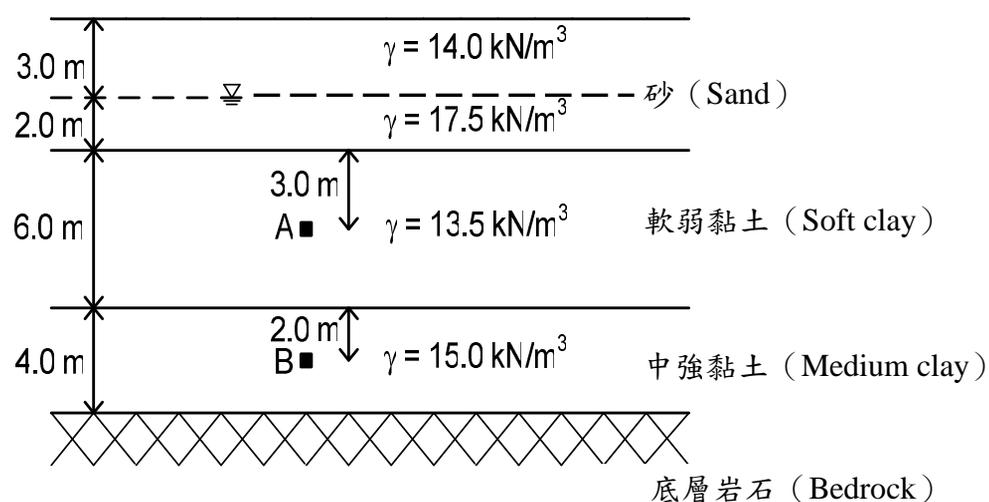
(一)回填土鋪設後，原土層表面之主要壓密沉陷 (Primary Consolidation) 為何？
